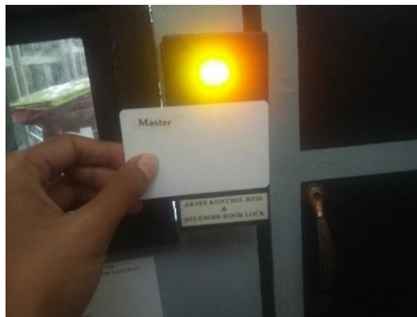
Gambar 10. Implementasi Kontrol RFID dan tag RFID
